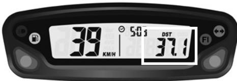
**Función DST diario kilométrico (pantalla 1):** amuestra el kilometraje parcial recorrido por el vehículo desde la última puesta a 0. La distancia parcial se muestra según la unidad elegida en km/h (reglaje por defecto) o en mph (☛ p.145) Puesta a 0 → función DST → botón derecho presionado 3s → 0.0 → puesta a 0 realizada
