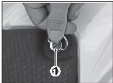
Déverrouiller d'un quart de tour dans le sens inverse des aiguilles d'une montre la vis Dzeus **1** de la selle.
