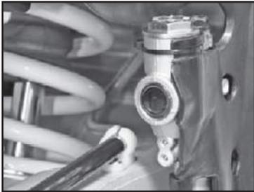
Colocar la moto sobre una superficie plana. Comprobar el nivel del líquido mediante el indicador.
