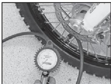
Regelmäßig mit einem Präzisionsmanometer den Reifendruck prüfen.
