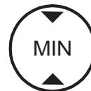
Falls der Stand unterhalb der Markierung MIN liegt, gemäß den nachfolgenden Anweisungen Flüssigkeit auffüllen.
