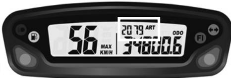
**Función ART horas de funcionamiento (pantalla 3)** amuestra las horas de funcionamiento del vehículo.
