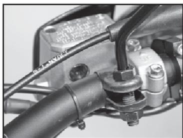
Poner la boquilla en posición horizontal. Comprobar el nivel del líquido mediante el indicador.
