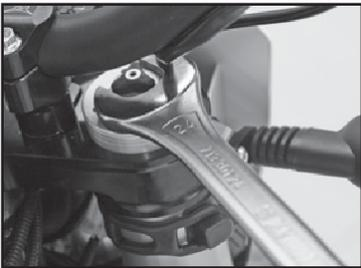
Mit der Einstellmutter kann die Vorspannung der Feder eingestellt werden. Das Drehen der Mutter im Uhrzeigersinn erhöht die Vorspannung (und umgekehrt).
