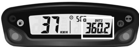
**Función DST2 diario kilométrico (pantalla 2):** muestra el kilometraje parcial recorrido por el vehículo desde la última puesta a 0. La distancia parcial se muestra según la unidad elegida en km/h (reglaje por defecto) o en mph. (☛ p.145) Puesta a 0 → función DST2 → botón derecho presionado 3s → 0.0 → puesta a 0 realizada
