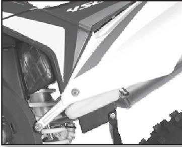
Comprobar el nivel de líquido en el depósito de expansión.
