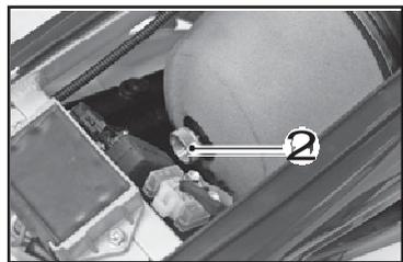
Réinstaller le filtre avec son support en prenant un soin particulier à son centrage. Remonter la vis moleté **2**. Vérifier que le filtre à air est bien en place. Remonter la selle (→ p.35)
