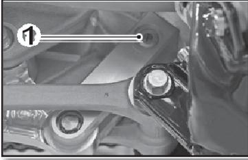
El tornillo de reglaje **1** determina el comportamiento del amortiguador en distensión. Girar el tornillo hacia la derecha aumenta el freno hidráulico (y viceversa).
