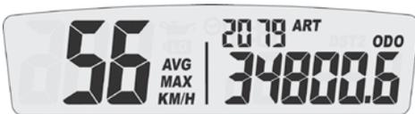
Display 3: Wechsel der Geschwindigkeit AVG/MAX, Betriebsstunde, ODO
